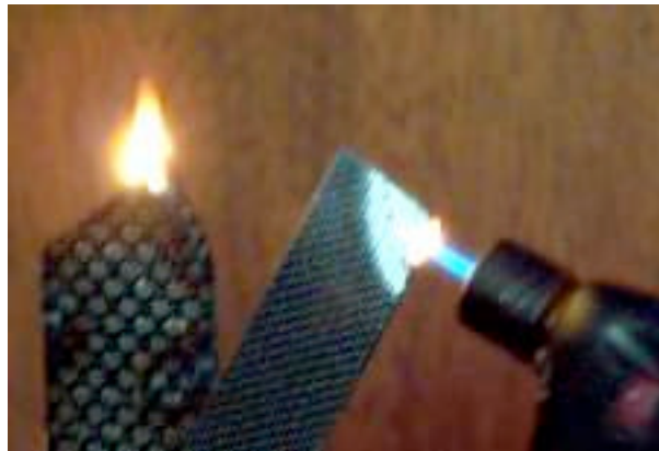
Un composite carbone-époxy de l'Aérospatiale (à gauche) est en train de brûler alors qu'un composite carbone-géopolymère (à droite) résiste toujours à une flamme de 1.200°C.
